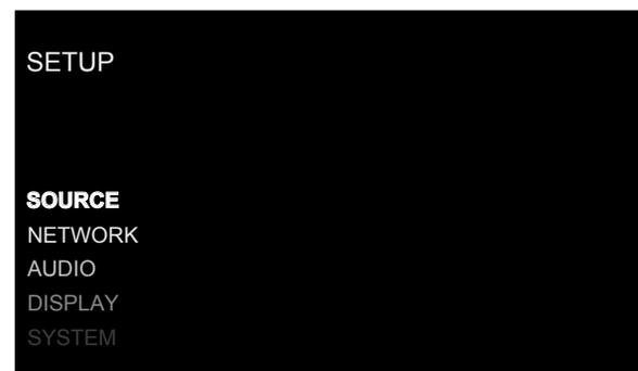
Über das Hauptmenü erhalten Sie Zugriff auf den OSD-Bildschirm mit den verschiedenen Konfigurationsoptionen. Um das Einstellungsmenü aufzurufen, betätigen Sie einfach die SETUP-Taste H auf der Fernbedienung. Verwenden Sie die Pfeiltasten nach ^/∨ (D), um zum gewünschten Menü zu navigieren, und drücken Sie anschließend die (K)-Taste auf der Fernbedienung. Drücken Sie erneut die SETUP-Taste um zum vorherigen Menü zurückzukehren oder das OSD-Menü zu verlassen und das Setup zu beenden.
