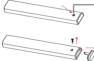
3. Legen Sie bitte nun die Batterien wie in der Abbildung beschrieben in das Batteriefach ein (Figure 2) und beachten dabei die negative und positive Markierung (Figure 1). Montieren Sie bitte nun den Batteriefachdeckel wieder und ziehen die Schraube vorsichtig mit dem Inbuswerkzeug an. Überprüfen Sie bitte anschließend die Funktionsweise.
