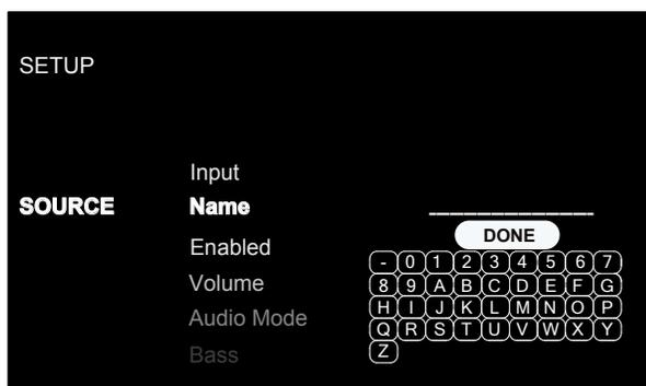
1. Drücken Sie die Pfeiltasten nach  $\wedge/\vee$  (D) auf der Fernbedienung, um den ersten Buchstaben zu ändern, indem Sie durch die Liste der zur Verfügung stehenden Zeichen scrollen.
