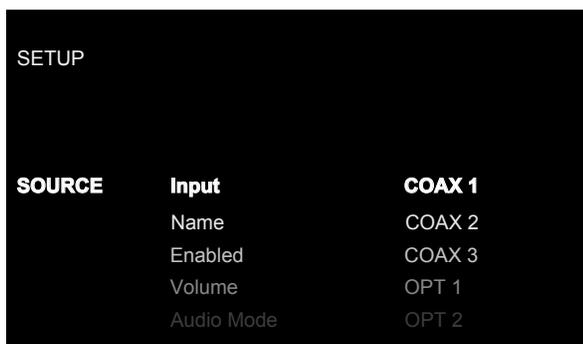
Ein wesentlicher Schritt bei der Einrichtung des Gerätes ist die Konfiguration der einzelnen Quelleneingänge über das SOURCE-SETUP. Bei der Konfiguration der Eingänge können Sie für einige Einstellungen Standardwerte festlegen, wie z. B. den Eingangsanschluss, den gewünschten Audiomodus, die benutzerdefinierte Benennung, die bei der Auswahl einer Quelle im Display erscheinen soll, und vieles mehr.
