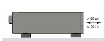
**ATTENTION :** La prise d'alimentation située à l'arrière constitue le principal moyen pour déconnecter l'appareil du secteur. Cet équipement doit être positionné dans un espace ouvert qui permet de garder l'accès au câble d'alimentation.
