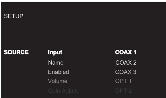
Ключевым этапом в настройке предусилителя является конфигурирование каждого входного источника при помощи экранов меню SETUP. Конфигурирование входов позволяет вам установить значения по умолчанию для ряда настроек, включая тип входного разъема, желаемый режим окружающего звука, задаваемое пользователем название, которое появляется на экранах при выборе источника, и многое другое.
