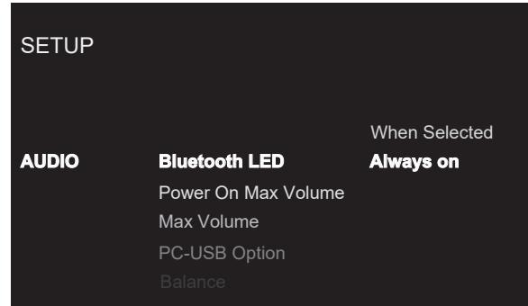
Подменю Audio в меню настройки Setup, обеспечивает выбор следующих вариантов, выбираемых выделением кнопками со стрелками  $\wedge/\vee$  (D) и нажатием кнопки Enter (K). В правой части дисплея выводятся опции, которые можно изменить. Изменяйте их с помощью кнопок  $\wedge/\vee$  (D) и нажимайте на кнопку Enter (K) для подтверждения.
