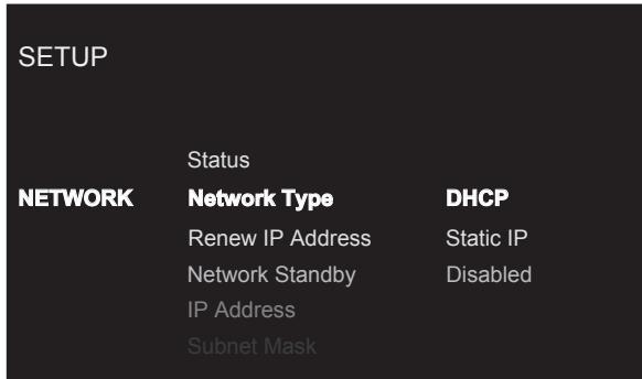
Подменю Network в меню настройки Setup обеспечивает выбор следующих вариантов, выбираемых выделением кнопками со стрелками  $\wedge/\vee$  (D) и нажатием кнопки Enter (K). В правой части дисплея выводятся опции, которые можно изменить. Изменяйте их с помощью кнопок  $\wedge/\vee$  (D) и нажимайте на кнопку Enter (K) для подтверждения.
