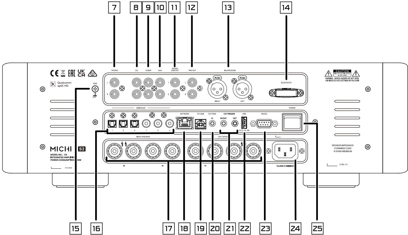
**7**: Вход для проигрывателя виниловых пластинок «Phono»
