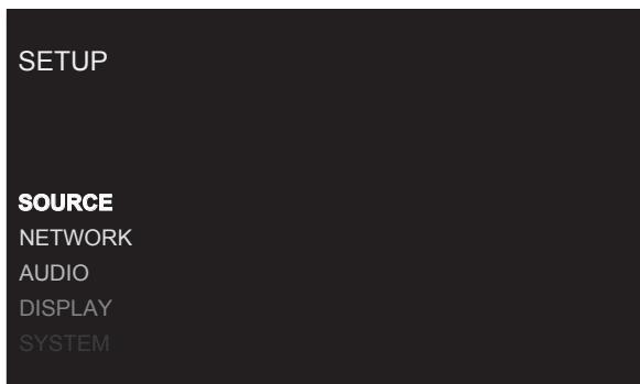
Главное меню MAIN MENU обеспечивает доступ в OSD экраны для различных вариантов конфигурации. До MAIN MENU можно добраться, нажав на кнопку SETUP. Чтобы попасть в желаемое меню перемещайте выделение с помощью кнопок курсора  $\wedge/\vee$  [D] на пульте, а затем нажмите кнопку Enter [K]. Нажмите кнопку SETUP [B] на пульте ДУ еще раз вернуться в предыдущее меню или выберите "EXIT" в меню OSD, чтобы отменить настройку и возвратиться к нормальной работе.
