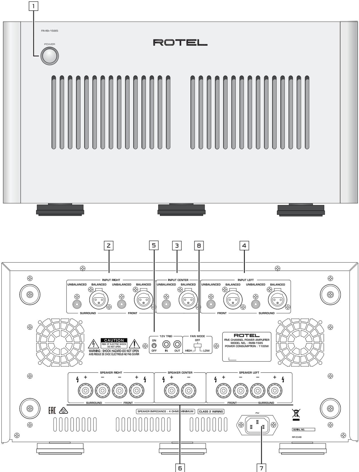
图 2: 模拟输入与音箱输出连接
