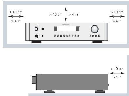
**ПРЕДОСТЕРЕЖЕНИЕ:** Сетевой разъем на задней панели предназначен для быстрого отсоединения устройства от электрической сети. Устройство должно обеспечивать свободный доступ к задней панели, чтобы сетевой кабель можно было быстро выдернуть.
