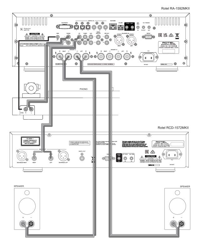
Figure 4: Digital Input and 12 Volt Trigger Connections Entrées numériques et Branchements des trigger 12 V Anschlussdiagramm (Digitaleingänge, 12V-Trigger) Entrada Digital y Conexiones para Señal de Disparo de 12 Voltios Digitale ingangen en 12V-trigger Collegamenti ingressi digitali e segnali Trigger 12 V Anslutningar för digitala ingångar och 12-volts styrsignaler Цифровой вход и 12-В триггерного сигнала
