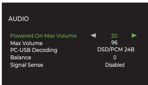
Подменю Audio в меню настройки Setup, обеспечивает выбор следующих вариантов, выбираемых выделением кнопками со стрелками  $\wedge / \vee$   $\text{B}$  и нажатием кнопки ОК  $\text{K}$ . В правой части дисплея выводятся опции, которые можно изменить. Изменяйте их с помощью кнопок  $\wedge / \vee$   $\text{B}$ .
