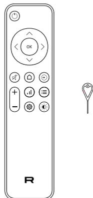
2. Вставьте прилагаемый инструмент в отверстие на задней панели пульта дистанционного управления, после чего крышка батарейного отсека откроется.
