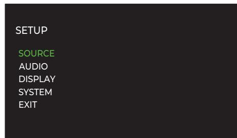
Главное меню MAIN MENU обеспечивает доступ в OSD экраны для различных вариантов конфигурации. До MAIN MENU можно добраться, нажав на кнопку SETUP [S] [G] [1]. Чтобы попасть в желаемое меню перемещайте выделение с помощью кнопок курсора [U] [D] на пульте, а затем нажмите кнопку OK [K]. Нажмите кнопку SETUP [S] [G] [1] на пульте ДУ еще раз вернуться в предыдущее меню или выберите "ВЫХОД (EXIT)" в меню OSD, чтобы отменить настройку и возвратиться к нормальной работе.
