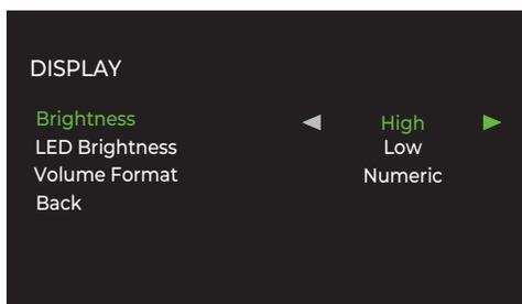
Подменю Display в меню настройки Setup, обеспечивает выбор следующих вариантов, выбираемых выделением кнопками со стрелками  $\wedge/\vee$  **(B)** и нажатием кнопки ОК **(K)**. В правой части дисплея выводятся опции, которые можно изменить. Изменяйте их с помощью кнопок  $\wedge/\vee$  **(B)**.
