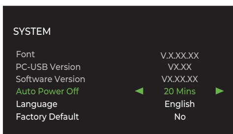
Подменю System в меню настройки Setup, обеспечивает выбор следующих вариантов, выбираемых выделением кнопками со стрелками  $\wedge/\vee$  **(B)** и нажатием кнопки ОК **(K)**. В правой части дисплея выводятся опции, которые можно изменить. Изменяйте их с помощью кнопок  $\langle/\rangle$  **(B)**.
