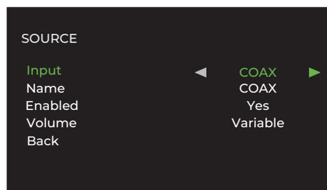
Ключевым этапом в настройке предусилителя является конфигурирование каждого входного источника при помощи экранов меню SETUP. Конфигурирование входов позволяет вам установить значения по умолчанию для ряда настроек, включая включить или отключить источник, и многое другое.
