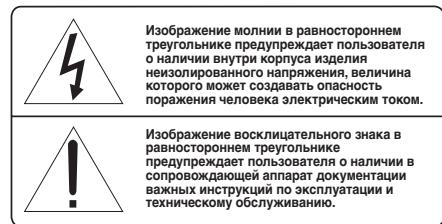
Изображение молнии в равностороннем треугольнике предупреждает пользователя о наличии внутри корпуса изделия неизолированного напряжения, величина которого может создавать опасность поражения человека электрическим током.
