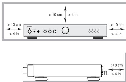
**ПРЕДОСТЕРЕЖЕНИЕ:** Сетевой разъем на задней панели предназначен для быстрого отсоединения устройства от электрической сети. Устройство должно обеспечивать свободный доступ к задней панели, чтобы сетевой кабель можно было быстро выдернуть.
