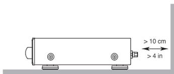
**WARNUNG:** Die Verbindung mit den Netz kann nur über den Netzeingang an der Geräterückseite unterbrochen werden. Das Gerät muss so aufgestellt werden, dass Sie freien Zugriff auf den Netzeingang haben.
