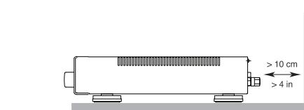
**ПРЕДОСТЕРЖЕНИЕ:** Сетевой разъем на задней панели предназначен для быстрого отсоединения устройства от электрической сети. Устройство должно обеспечивать свободный доступ к задней панели, чтобы сетевой кабель можно было быстро выдернуть.
