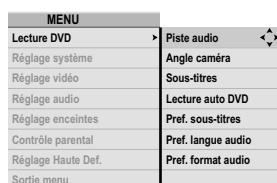
Il y a sept paramètres dans les options de lecture d'un DVD, quand un disque est inséré dans le RDV-1093. Si aucun disque n'est inséré, les quatre options concernant les paramètres de lecture automatique d'un DVD s'affichent automatiquement.
