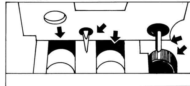
消磁 DEMAGNETIZING HEAD
