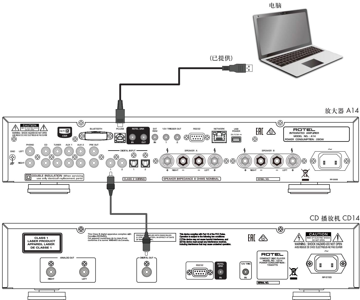
图 5: Rotel Link和12V触发连接
