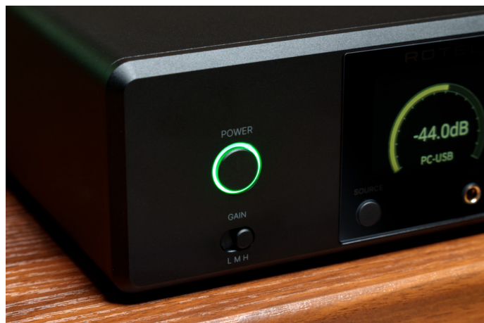
前面板左边是工作状态切换开关，开关下方是耳机放大器的增益调整
