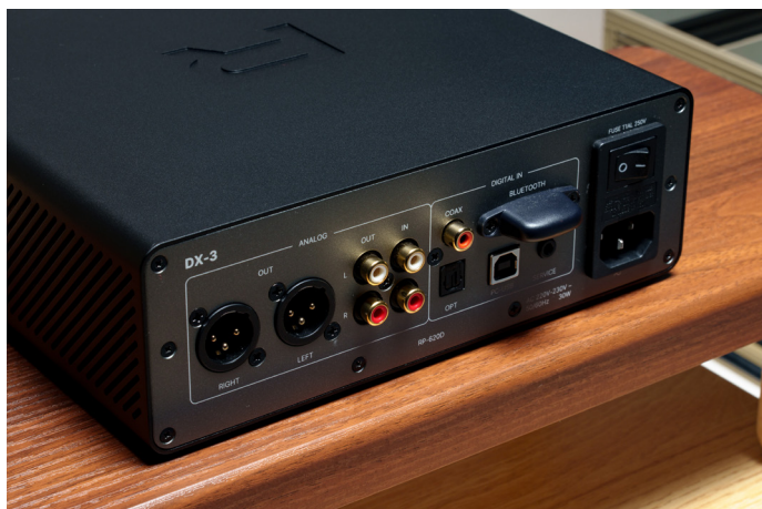
DX-3背部的接口，模拟输出部分有平衡与非平衡输出，数字部分有同轴，光纤和USB Audio，另外还有蓝牙接收天线
