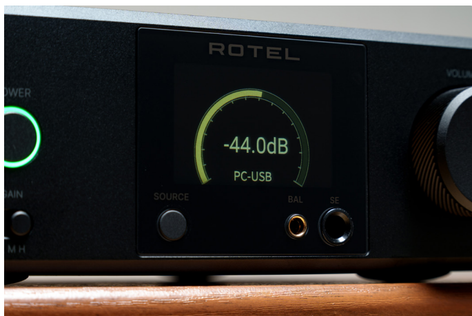
正前方中央位置是一个显示器，这个显示器可以很好的与前面板融合。另外，耳机后分别提供4.4平衡和6.35mm单端两种规格
