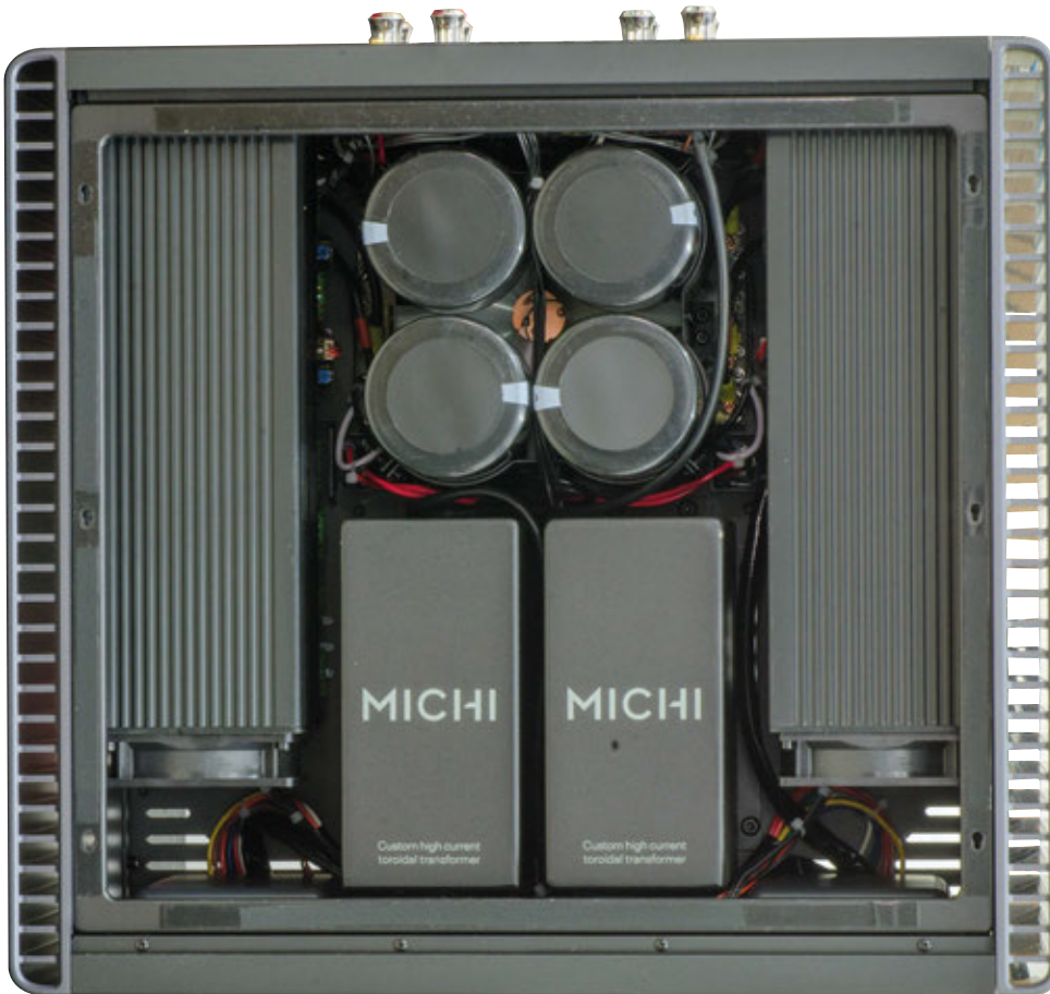
Dopo aver lavorato un po' per rimuovere la copertura superiore, siamo rimasti delusi nel constatare che la casa ha gelosamente nascosto il cuore della sua creatura. Le ventole di raffreddamento sono collocate all'interno del contenitore e immettono il flusso d'aria all'interno di due canali sui quali sono fissati i dispositivi attivi. Come nel pre, troviamo anche qui due trasformatori toroidali, progettati e realizzati internamente, incapsulati in resina per eliminare le vibrazioni. La sezione di filtraggio impiega 4 condensatori di fabbricazione inglese per una capacità totale pari a 188.000 microfarad. I dispositivi attivi della sezione finale sono in tutto ben 32.
