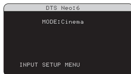
Cuando el DTS Neo:6 es seleccionado como el modo de sonido envolvente por defecto en el menú INPUT SETUP (ver sección anterior), se dispone de ajustes y parámetros adicionales para optimizar la descodificación de sonido envolvente correspondiente a grabaciones musicales o audiovisuales. El DTS Neo:6 utiliza algoritmos de descodificación matricial para obtener un canal central y canales de sonido envolvente a partir de grabaciones en 2 canales.
