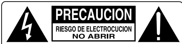
PRECAUCION: PARA REDUCIR EL RIESGO DE RECIBIR UNA DESCARGA ELECTRICA, NO QUITAR LA CUBIERTA SUPERIOR. NO HAY COMPONENTES MANIPULABLES POR EL USUARIO EN EL INTERIOR DEL APARATO. CUALQUIER OPERACION DE MANTENIMIENTO DEBE SER LLEVADA A CABO POR PERSONAL CUALIFICADO.
